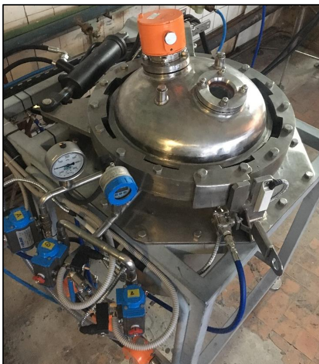
Полностью автоматический автоклав вакуумно-нагнетательной пропитки для АО «РАТЕП», Серпухов 2018
