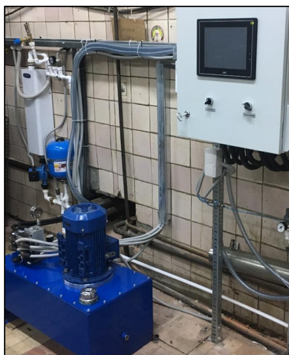
Полностью автоматический автоклав вакуумно-нагнетательной пропитки для АО «РАТЕП», Серпухов 2018
