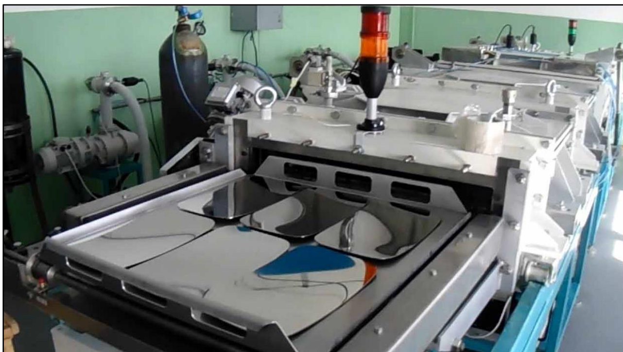
Проходная вакуумная установка магнетронного напыления, Бобрыйск 2015
