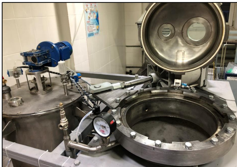
Установка вакуумно-нагнетательной пропитки для АО «НПО «Электромашина» Челябинск 2022
